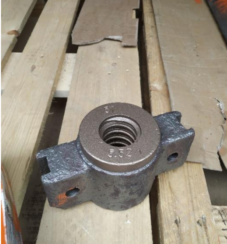
Aufgearbeitete Bronzegewindemutter des Schützenaufzugs Nach dem Sandstrahlen erstrahlt das Teil in neuem Glanz.
