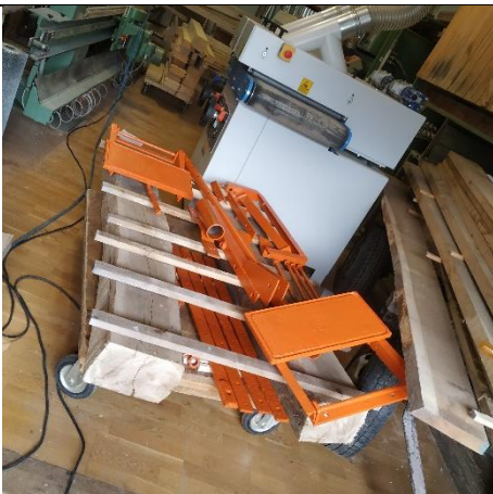
Schutzanstrich mit Eisenmennige Eisenmennige bietet einen hochfüllenden Korrosions-Grundanstrich für Eisen und Stahl.
